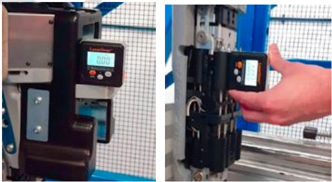
图 31 冲击器竖直状态测量
